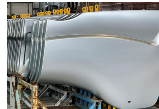
↗ Großformatige Karosseriebauteile in Außenhautqualität aus Stahl
