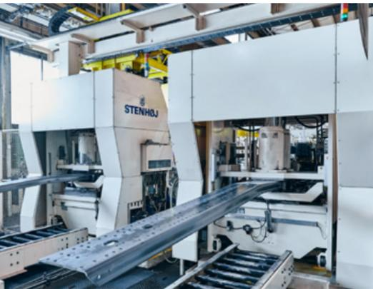
Knickanlage zum Knicken von Rahmenlängsträgern
