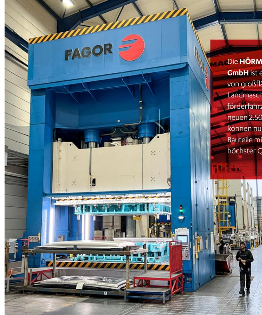
Die HÖRMANN Automotive St. Wendel GmbH ist ein Spezialist für die Herstellung von großflächigen Karosserieteilen für Landmaschinen, Baumaschinen, Flurförderfahrzeuge und Spezial-LKW. Mit der neuen 2.500-Tonnen-Hydraulikpresse können nun noch größere Bauteile und Bauteile mit höherem Umformgrad und höchster Qualität gefertigt werden.
