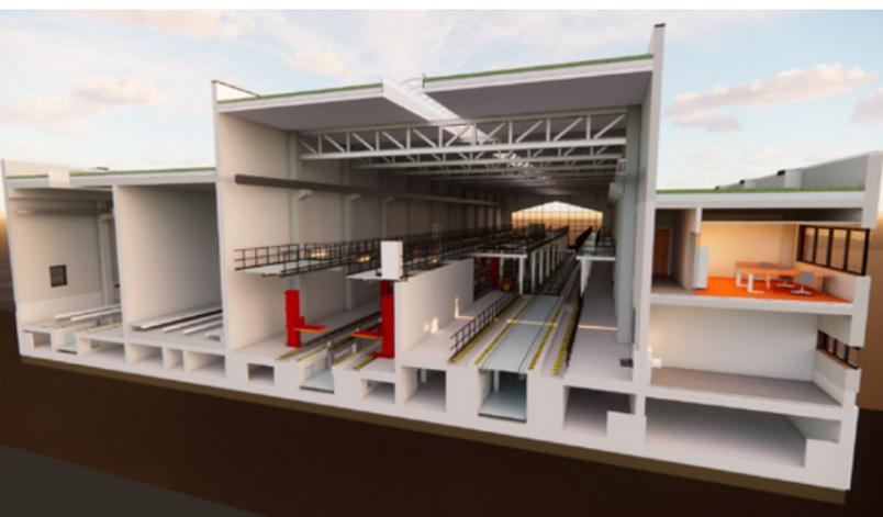
Die HÖRMANN BauPlan GmbH übernimmt alle Planungsleistungen (Leistungsphasen 1–9). Die Architekturabteilung plant das Werkstattgebäude des EBH. Um den komplexen Nutzeranforderungen und den Anforderungen des nicht optimalen Baugrunds gerecht zu werden, entwickelten die Architekten eine innovative Fundamentlösung mit einer 5.000 Quadratmeter großen Bodenplatte, die etwa drei Meter unterhalb des Geländes liegt.
