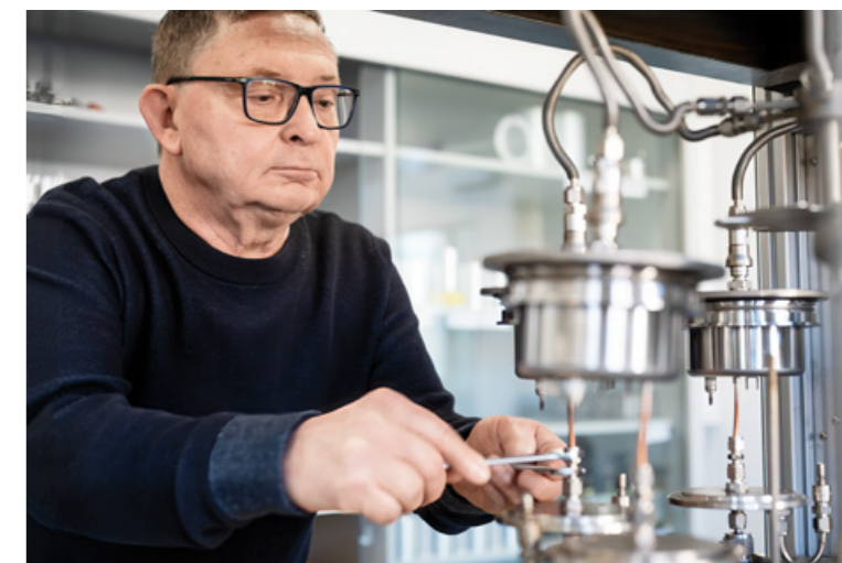
➤ Pumpstände zur Evakuierung der Luft und Füllung der Ionisationskammern mit Edelgas
